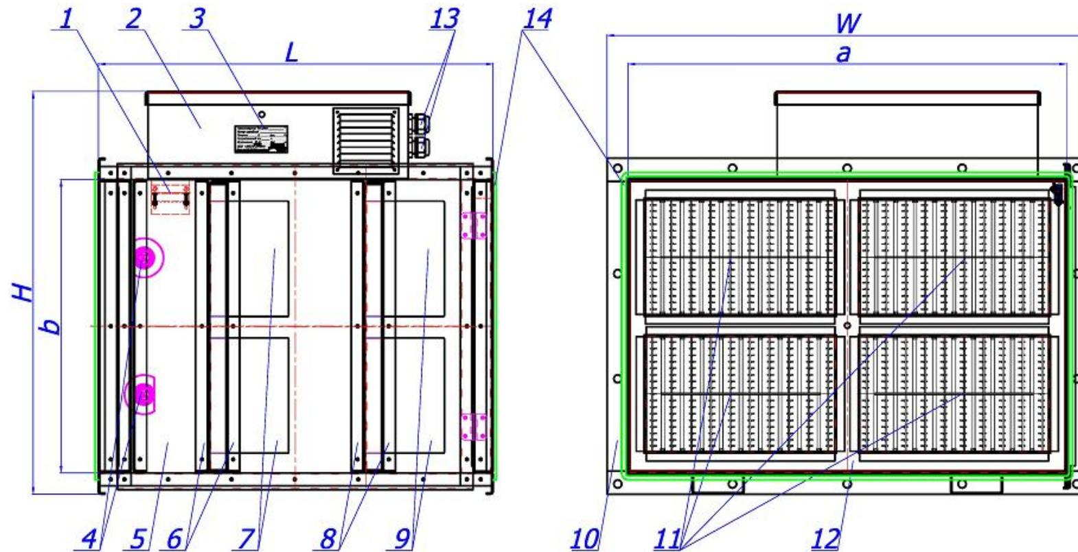
1 – Герконовый датчик; 2 – Блок высоковольтного питания; 3 – Шильдик (заводская табличка); 4 – Замки двери блока; 5 – Дверь блока; 6 – Направляющие ряда ячеек; 7 – Первый ряд ячеек; 8 – Направляющие 2-го ряда ячеек; 9 – Второй ряд ячеек; 10 – Фланец; 11 – Газоразрядные ячейки (ГРЯ); 12 – Рама-держатель ячеек; 13 – Кабельные вводы; 14 – Уплотнитель.
